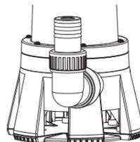
1. Limpie la turbina con agua a presión a través del prefiltro de la bomba.
